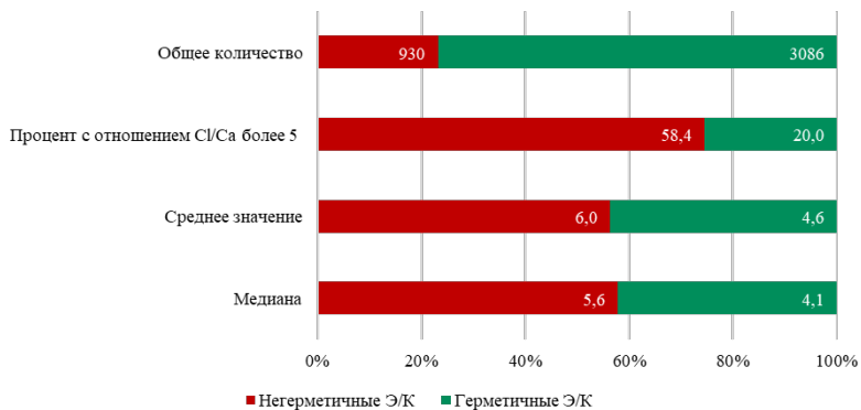
Рисунок 5. Распределение значений CI/Ca среди герметичных и негерметичных скважин
