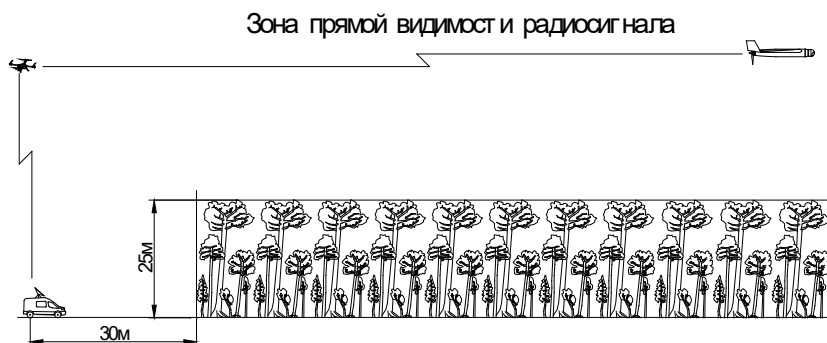
Рисунок 2. Применение коптера для передачи сигнала
