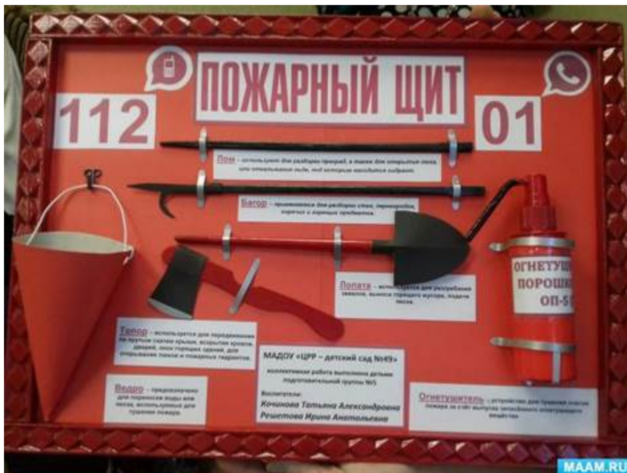
Рисунок 1. Устройство пожарного щита
