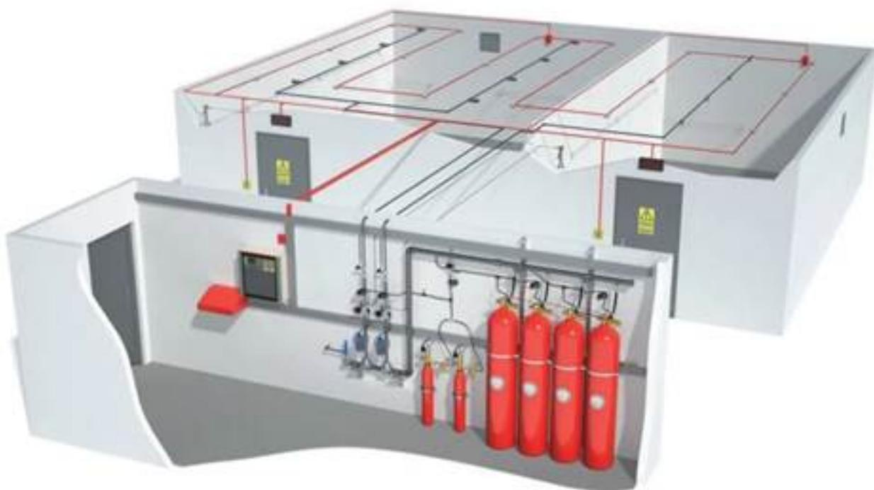
**Рисунок 1. Система автоматического пожаротушения.**
