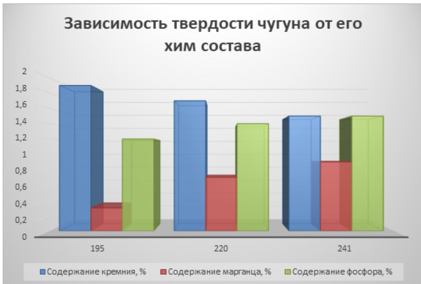
**Рисунок 2. Химический состав чугуна при разной величине твердости**
