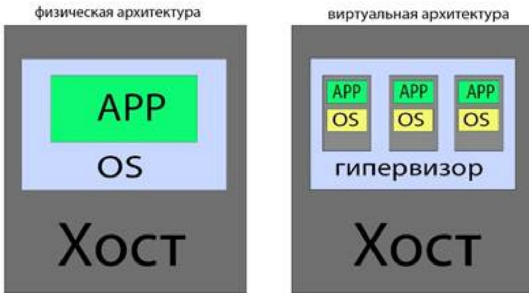
**Рисунок 1. Физическая и виртуальная архитектура**
