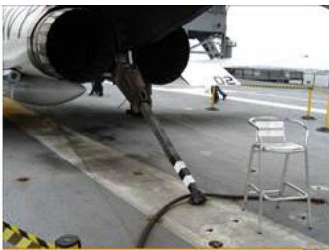
*Рисунок 2. Тормозной гак*
