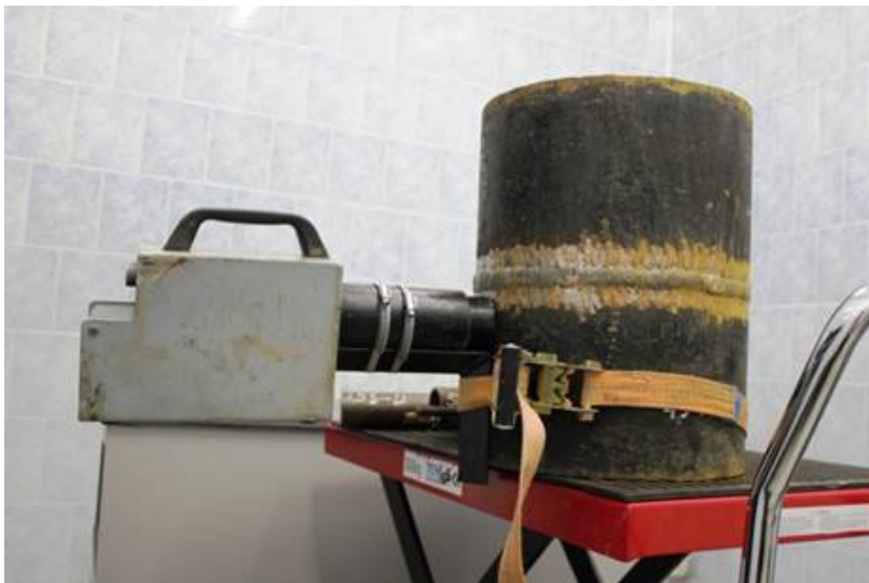
Рисунок 3. излучатель рентгеновских лучей устанавливается непосредственно на обращенную к источнику поверхность сварного соединения
