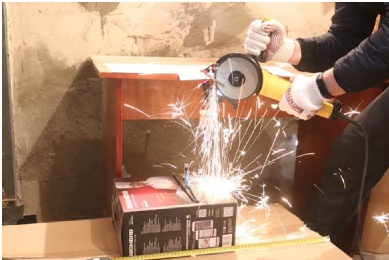
Рисунок 2. Искры, направленные под определенным углом для попадания на газовую зажигалку
