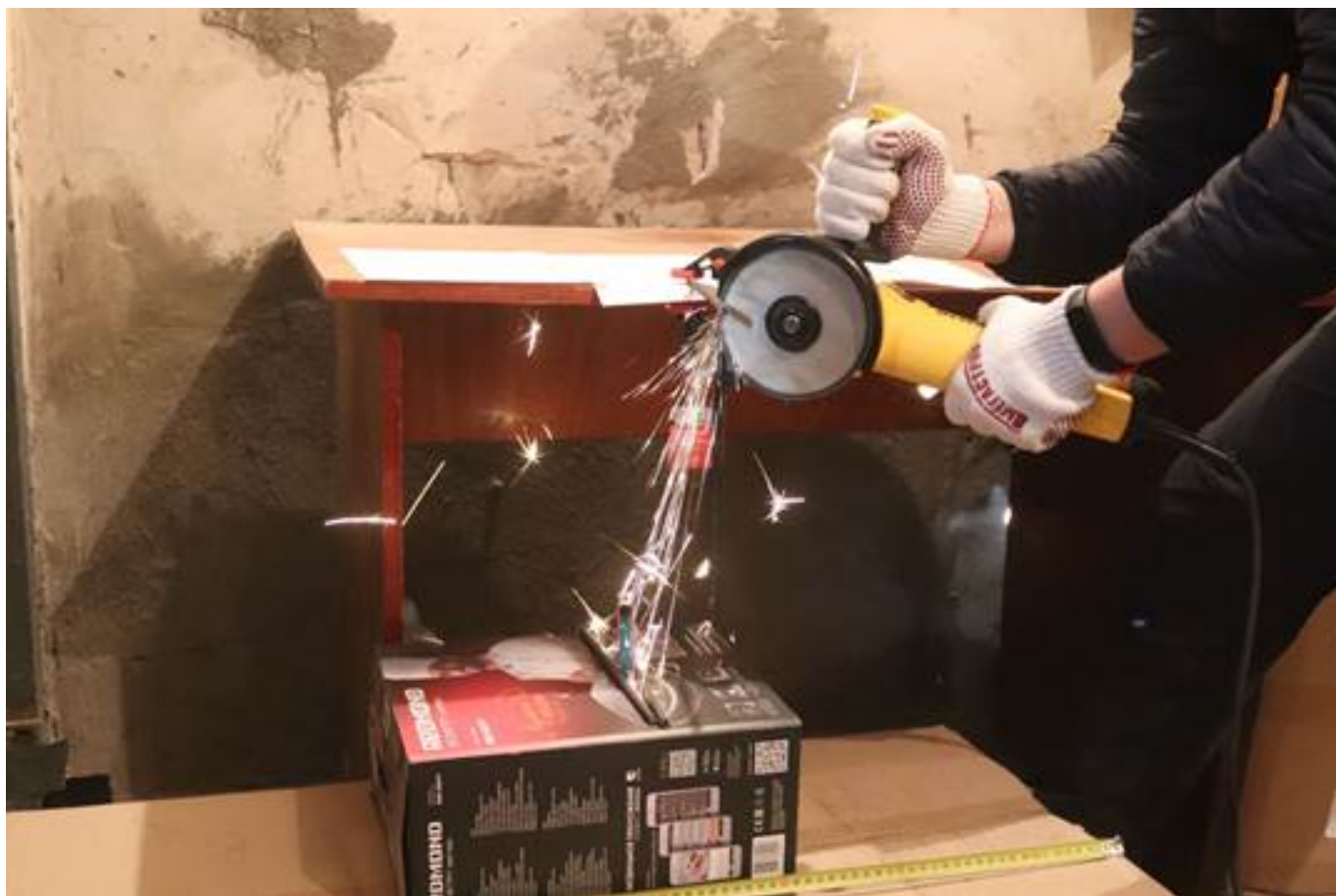
Рисунок 3. Искры, образованные при резке арматуры
