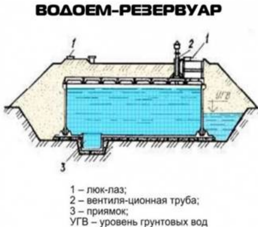
Рисунок 3. Устройство водоем - резервуара
