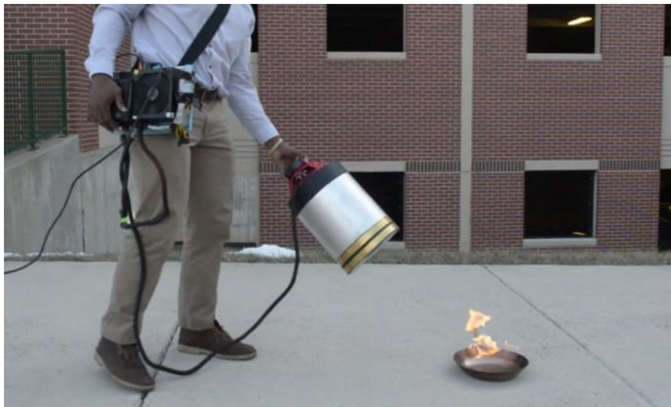
Рисунок 1. Применение звукового огнетушителя для тушения пламени
