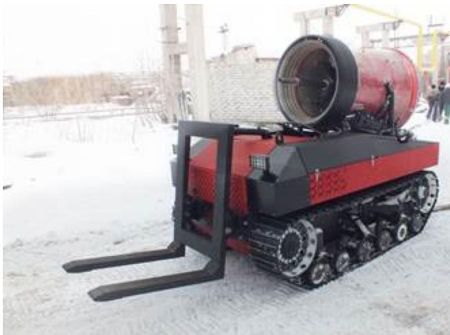
**Рисунок 2. Гусеничный беспилотный пожарный робот LUF 60**
