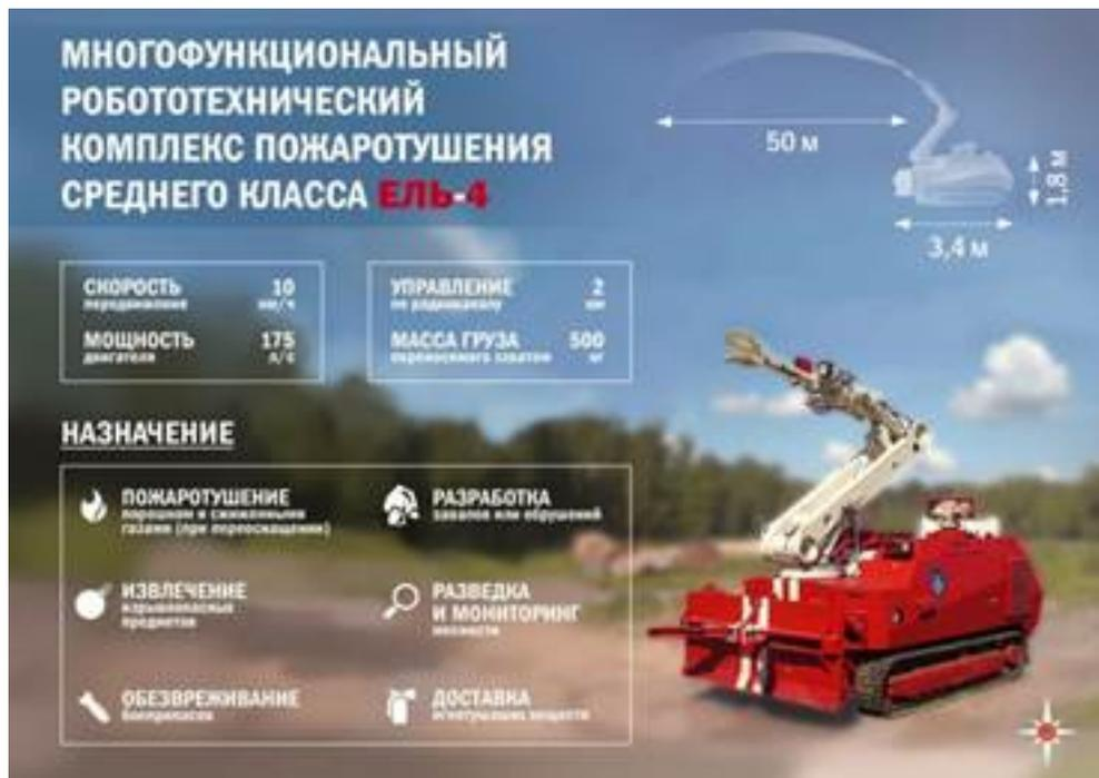
**Рисунок 1. Многофункциональный роботехнический комплекс пожаротушения среднего класса**
