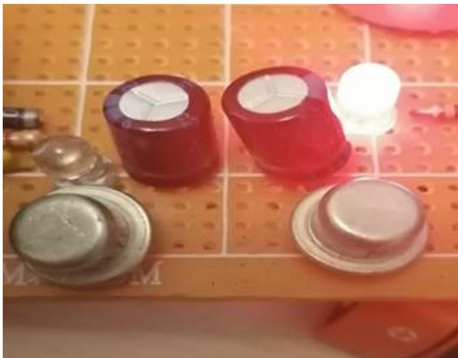
*Рисунок 2. Мигалка на двух светодиодах*
