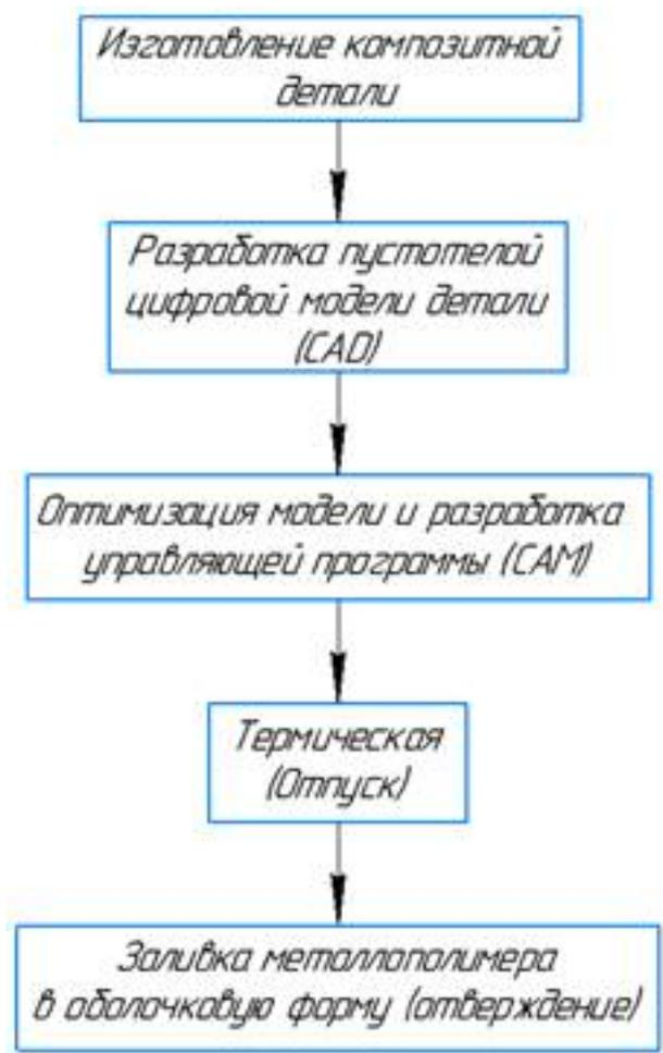
**Рисунок 5. Схема технологического процесса изготовления композитного рычага**
