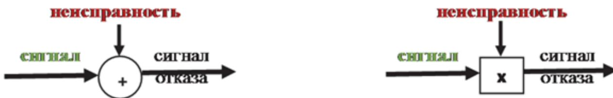
**Рисунок 2. Виды математического моделирования отказов органов управления самолетом**
