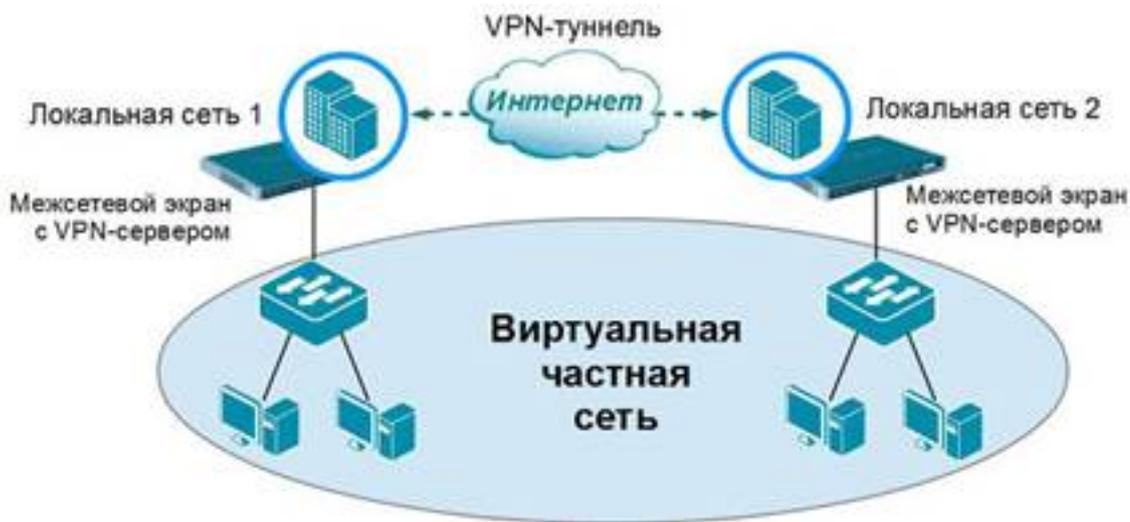
Рисунок 3. Архитектура VPN
