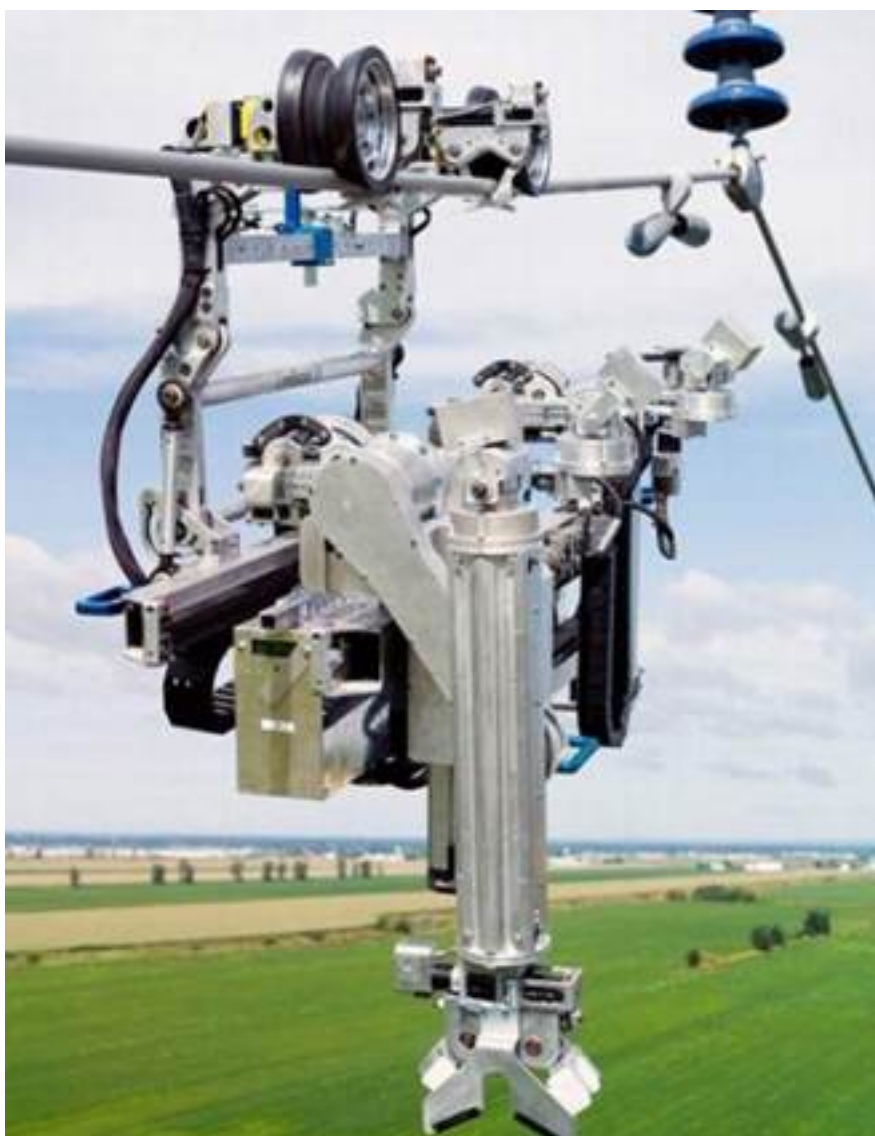
Рисунок 2. Робот LineScout на проводе ЛЭП
