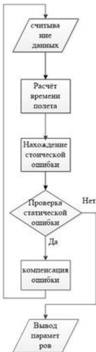
Рисунок 3. Алгоритм оптимизации скорости полета
