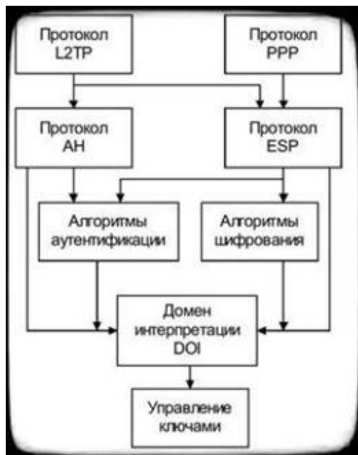
Рисунок 2. Архитектура протокола L2TP
