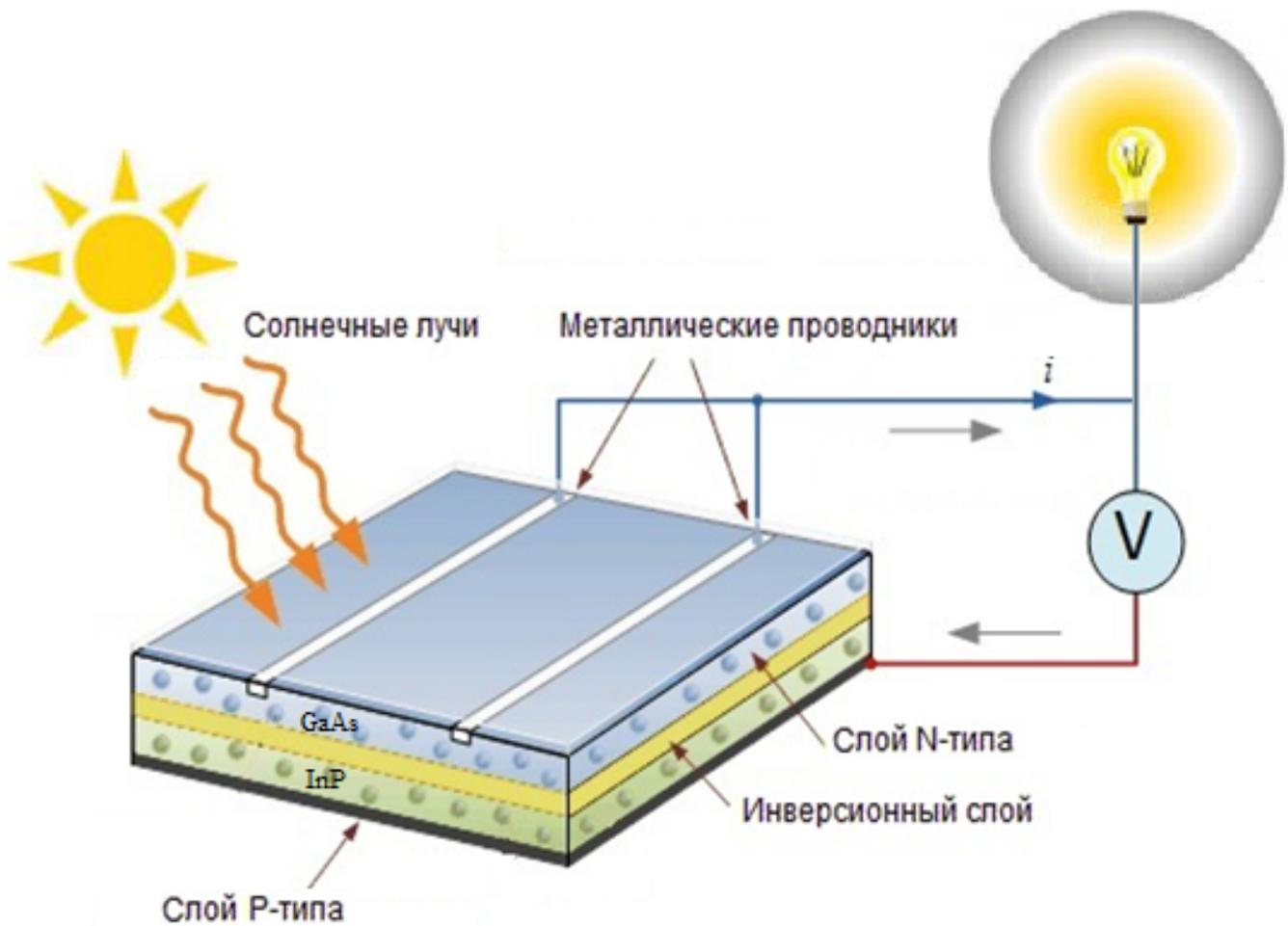
Рисунок 1. Структура солнечного элемента на основе гетероперехода InP -GaAs
