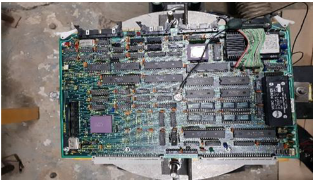
Рисунок 2. Плата, установленная на вибростенде
