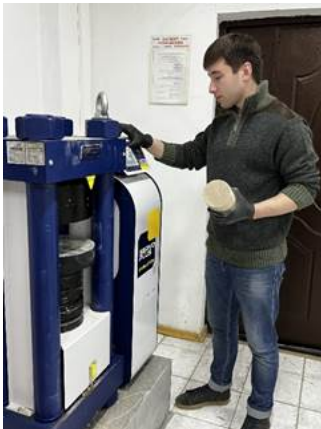
Рисунок 9. Гидравлический пресс MATEST C055 на 2000 кН
