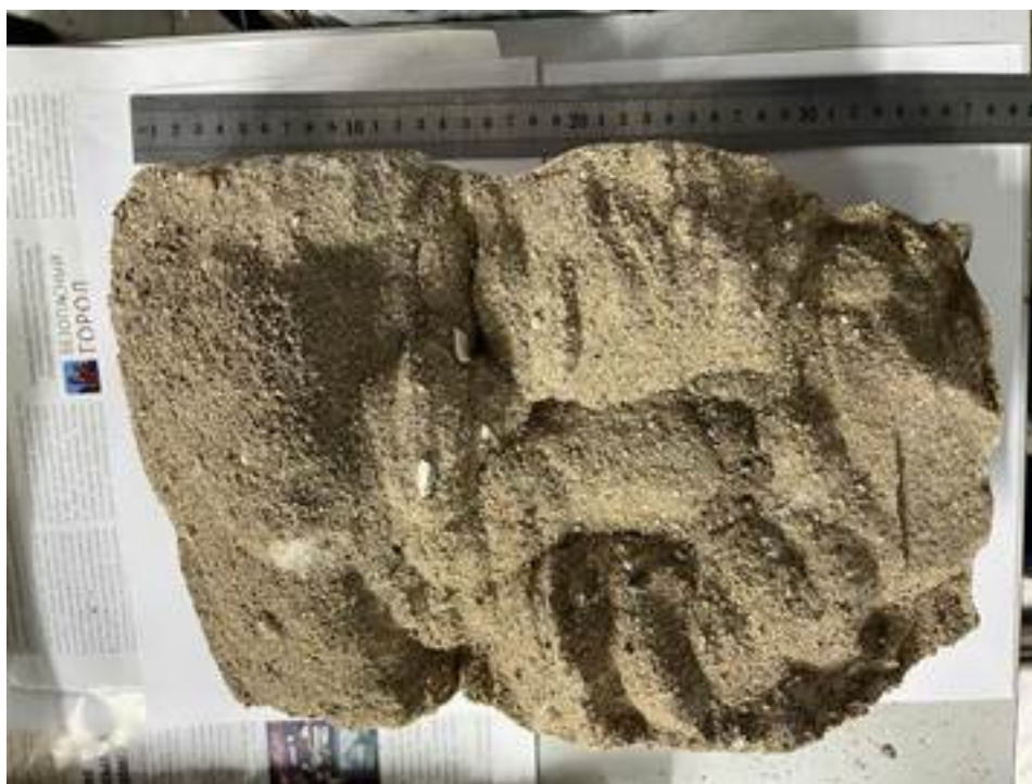
Рисунок 6. Пример закрепления песка двухкомпонентной смолой в лабораторных условиях
