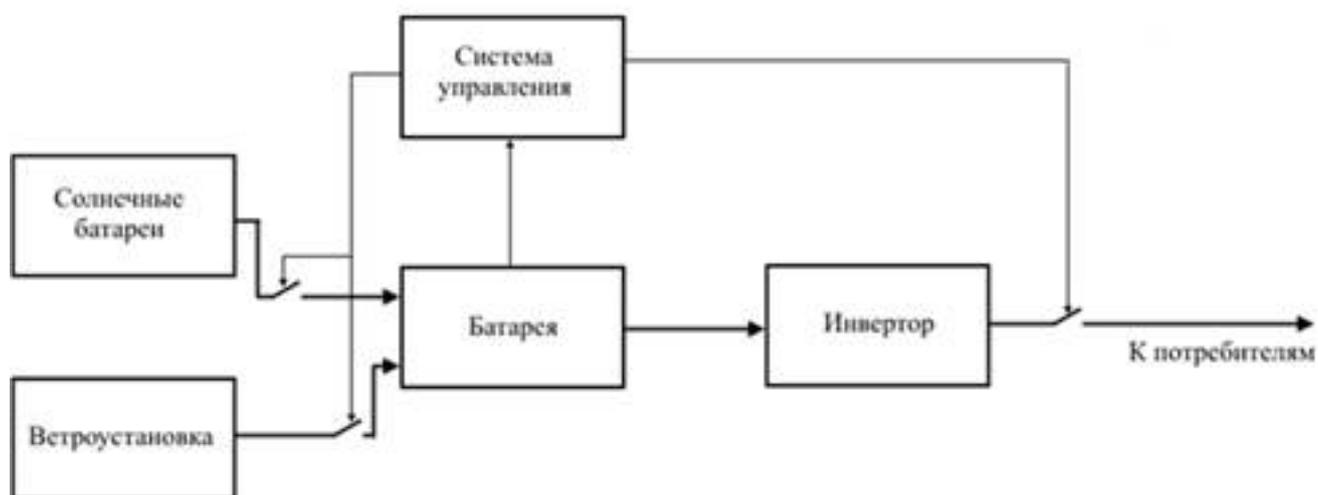
**Рисунок 1. Структура автономной системы**
