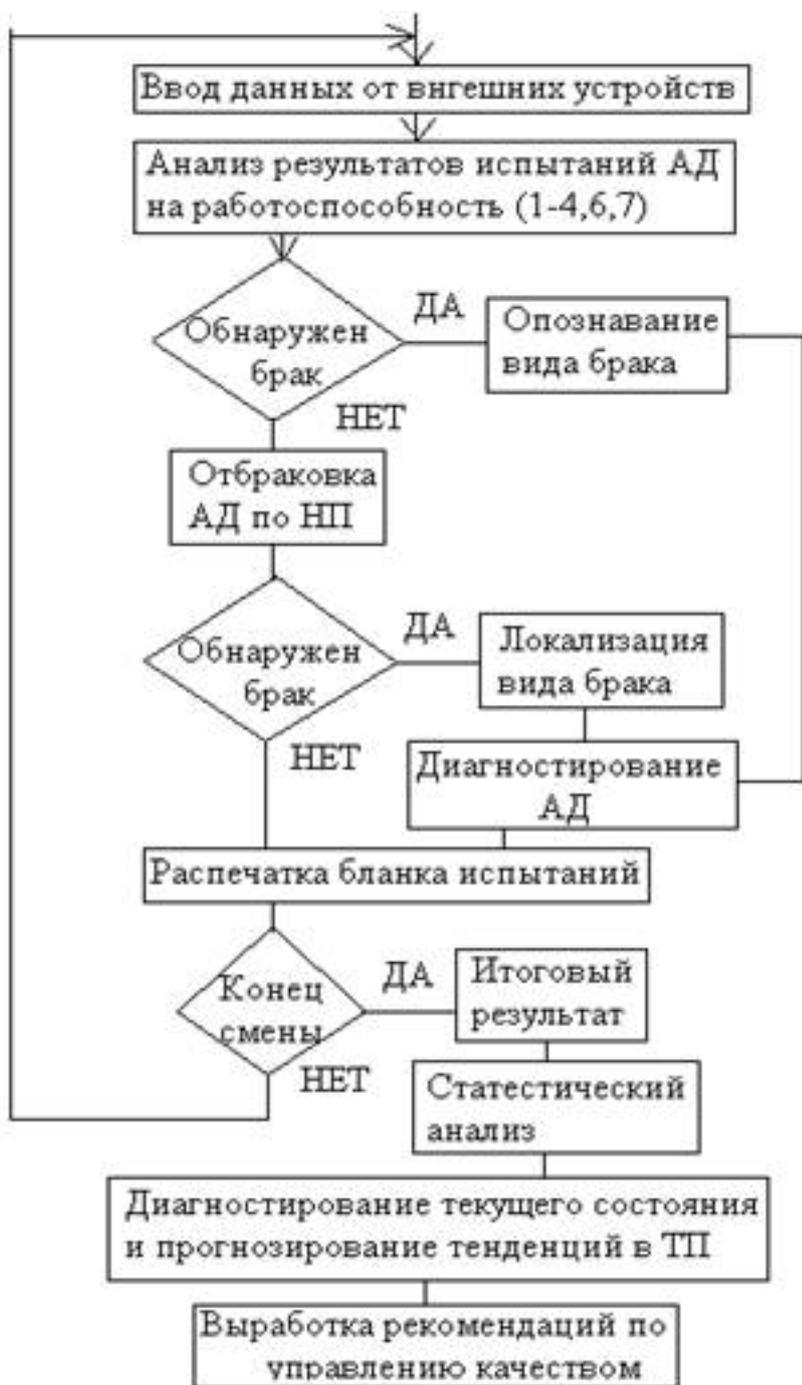
**Рисунок 5. Блок-схема алгоритма функционирования**
