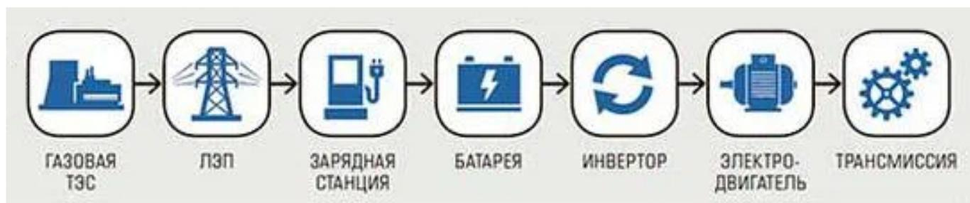
Рисунок 1. Элементы цепи снабжения энергией колес электромобиля
