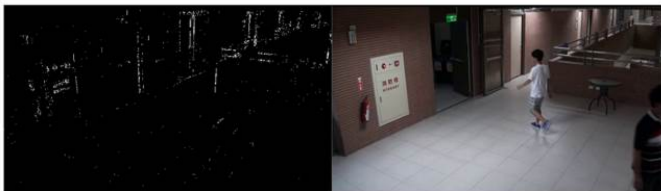
Рисунок 4. Устойчивый статический фон, полученный в результате накопления двух фонов
