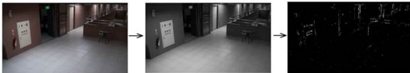
Рисунок 3. Построение долговременного фона и его бинаризация
