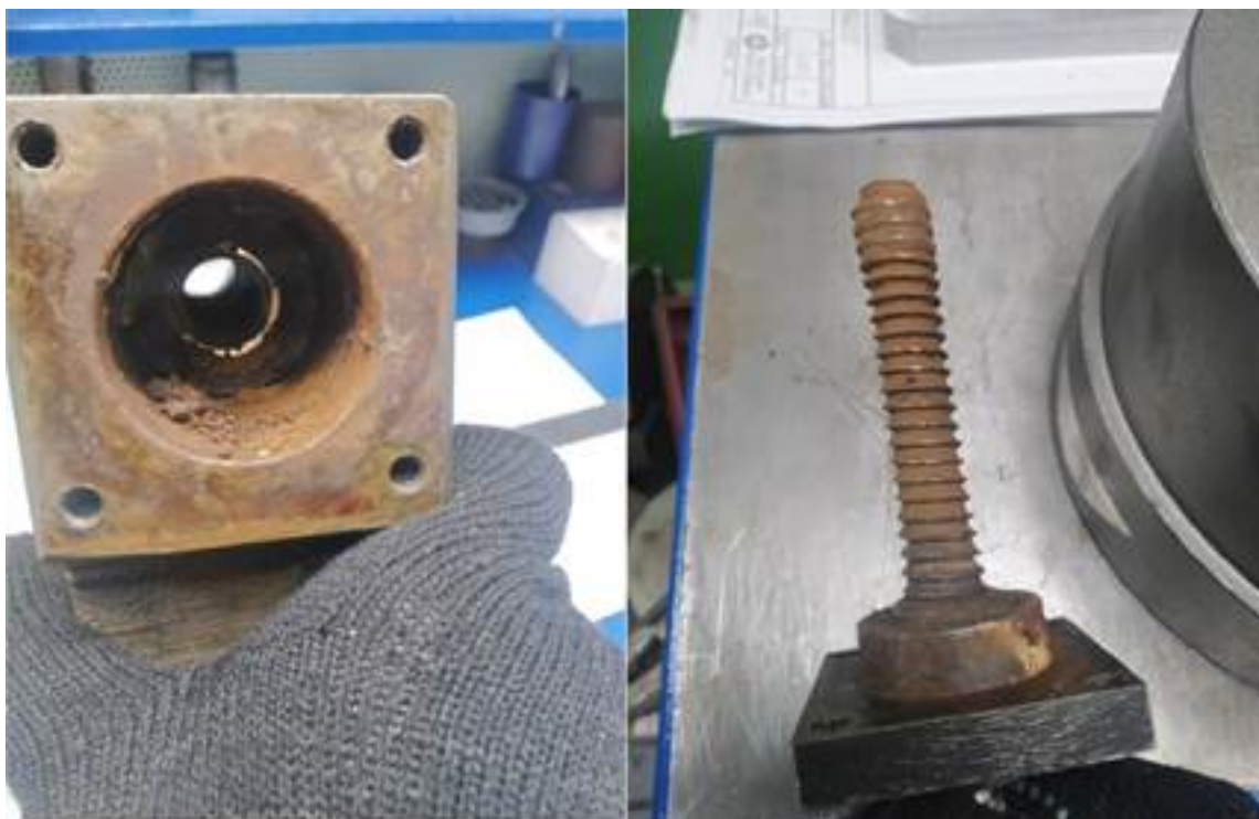
Рисунок 2. Коррозия и износ рабочих поверхностей
