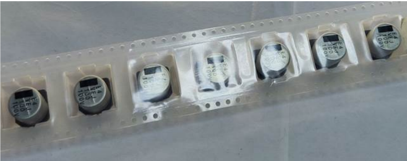
Рисунок 2. Примеры неоднородностей яркости на блистерной ленте
