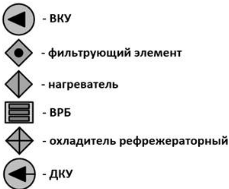
Рисунок 3. Обозначения устройств технологической схемы МАУК
