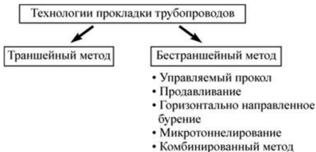
Рисунок 1. Классификация методов прокладки трубопроводов [1]
