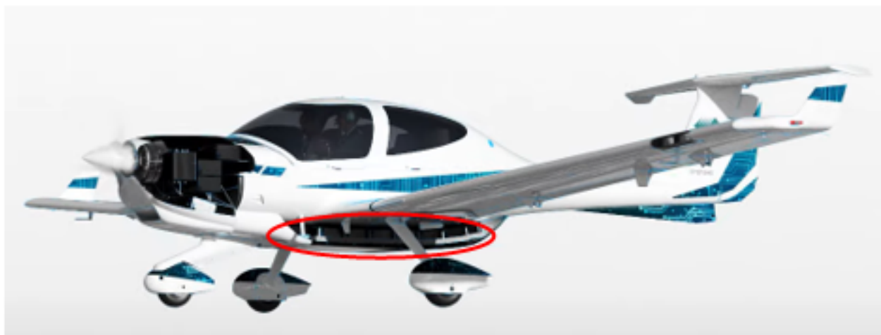
Рисунок 7. Расположение АКБ на самолете eDa-40
