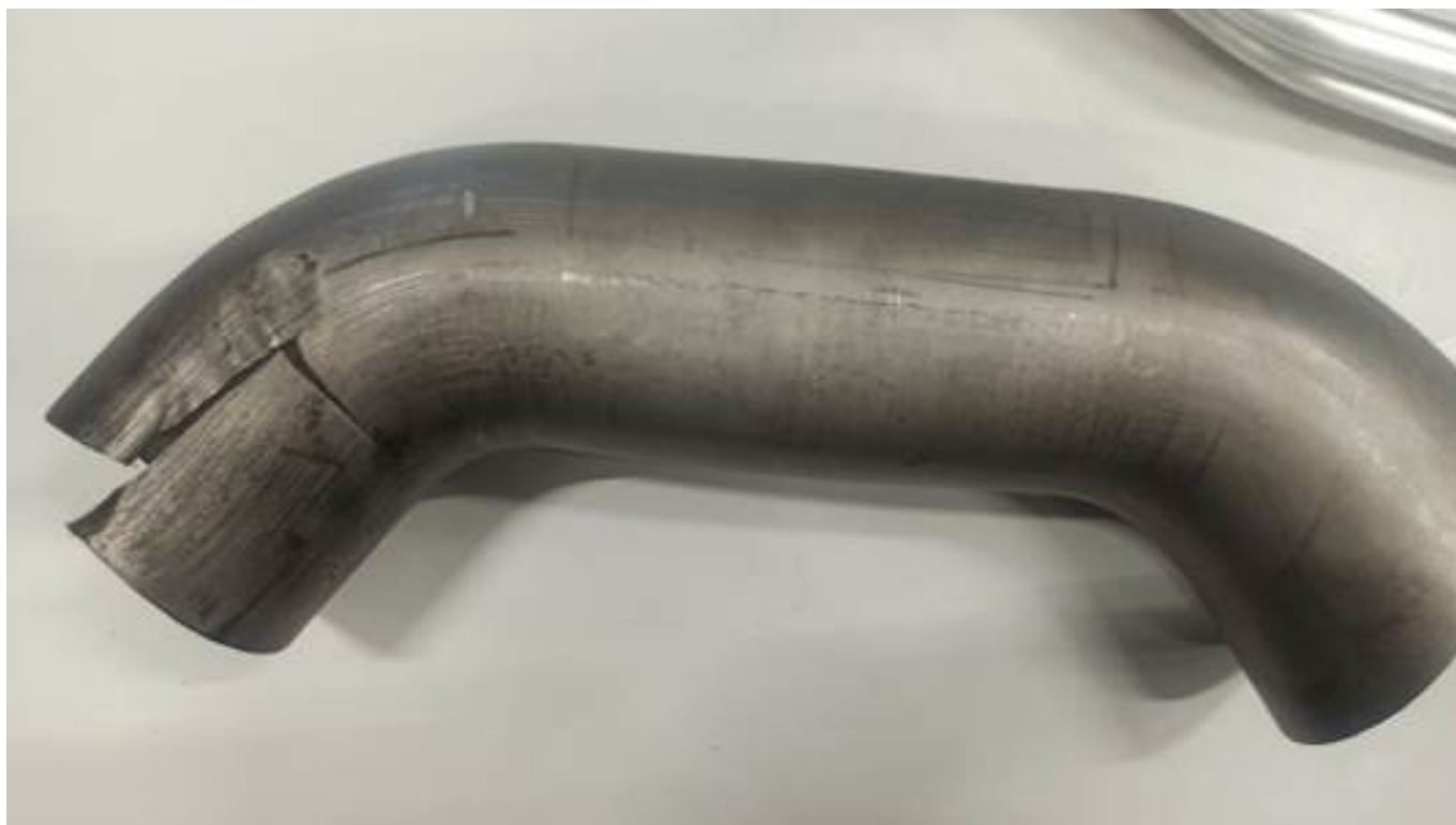
Рисунок 3. Примеры труб с образованием заломов, гофр и разрыва стенки трубы
