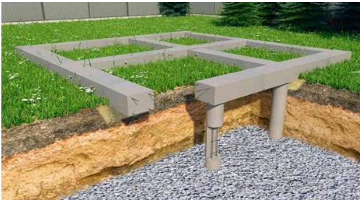
Рисунок 1. Ленточный свайный фундамент
