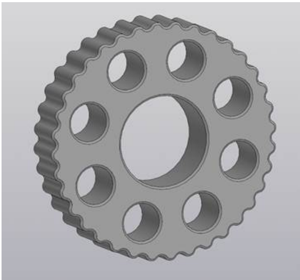
Рисунок 3. Рабочее колесо циклоидального редуктора
