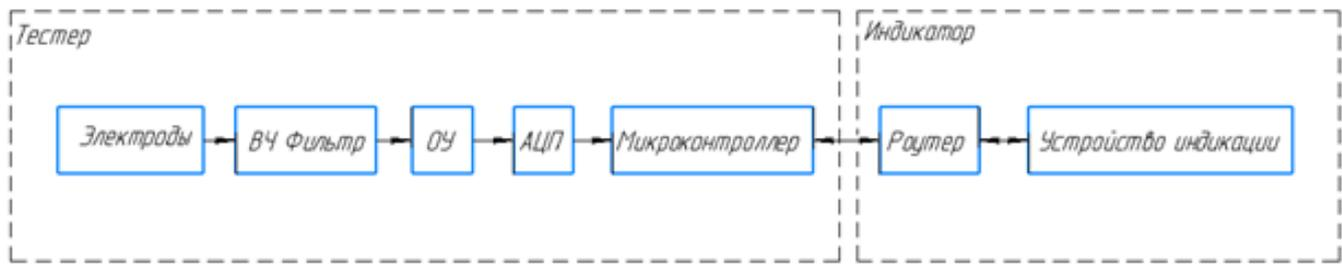
Рисунок 1. Функциональная схема универсального тестера омега-потенциала
