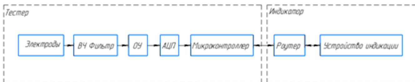
Рисунок 1. Функциональная схема тестера функциональных систем человека
