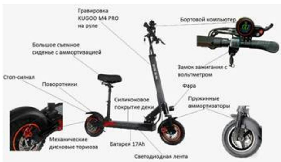
**Рисунок 2. Строение электросамоката**
