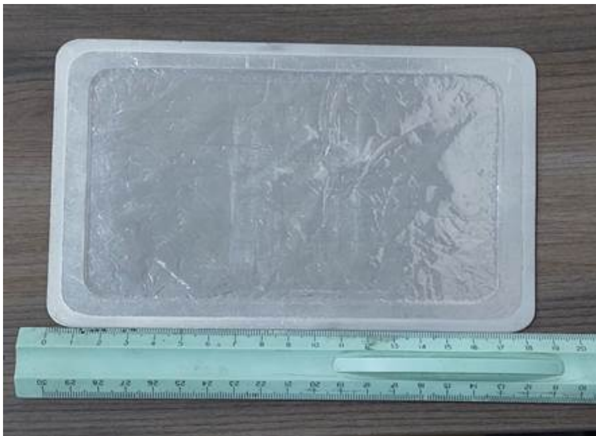
Рисунок 1. Фотография эталонного бета-источника ^{60}\text{Co} со стороны активной области
