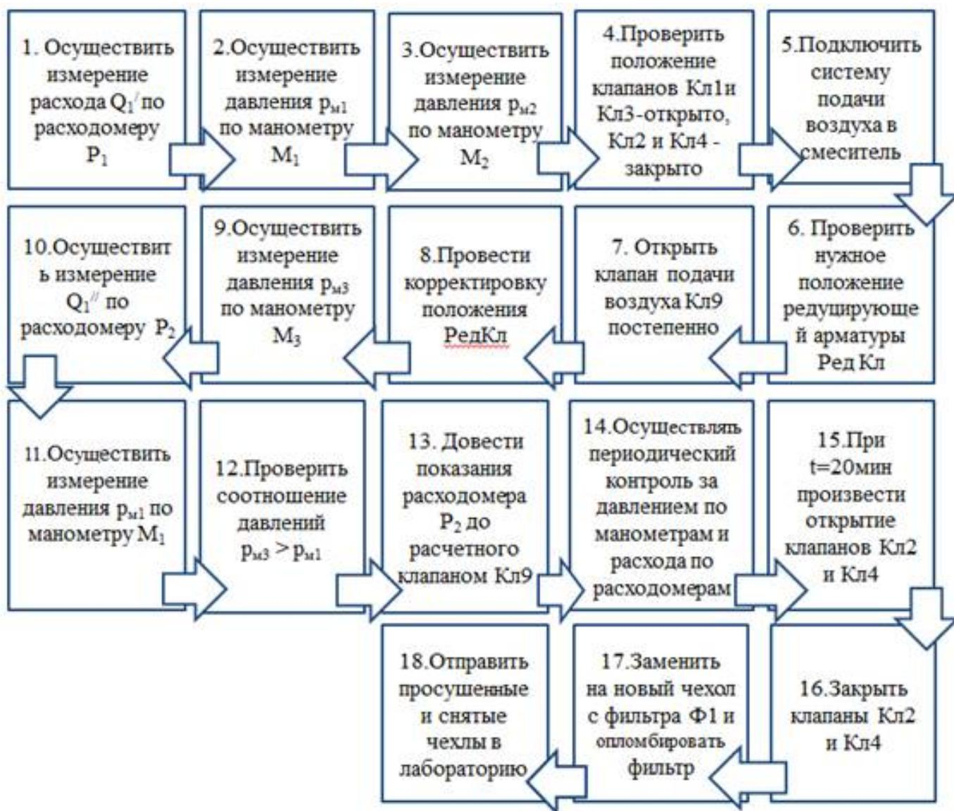
**Рисунок 5. Второй цикл промывки двухфазным потоком**
