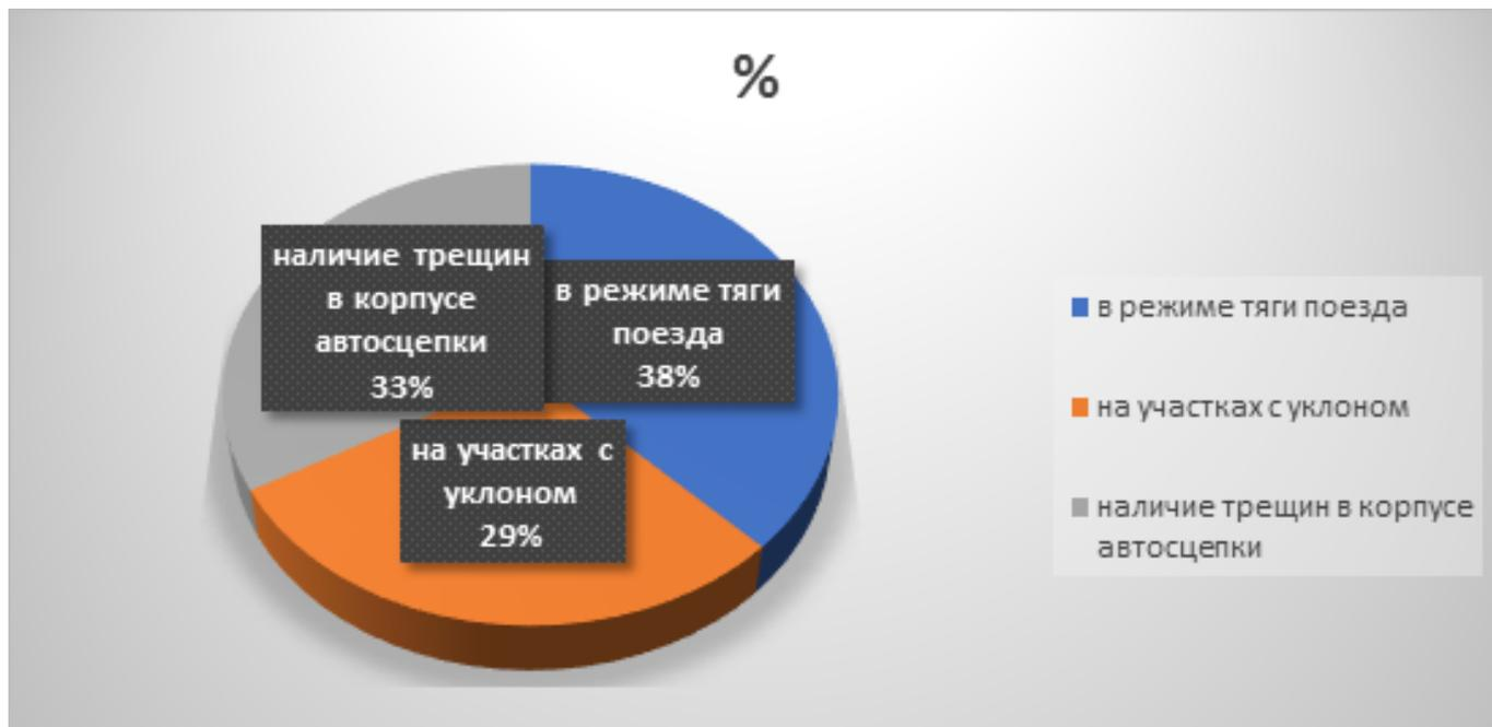
**Рисунок 3. Неисправности автосцепного устройства**
