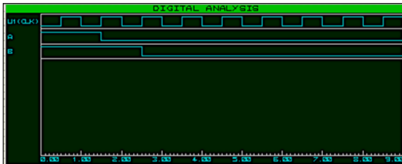
Рисунок 2. Временная диаграмма сдвиговых регистров входа
