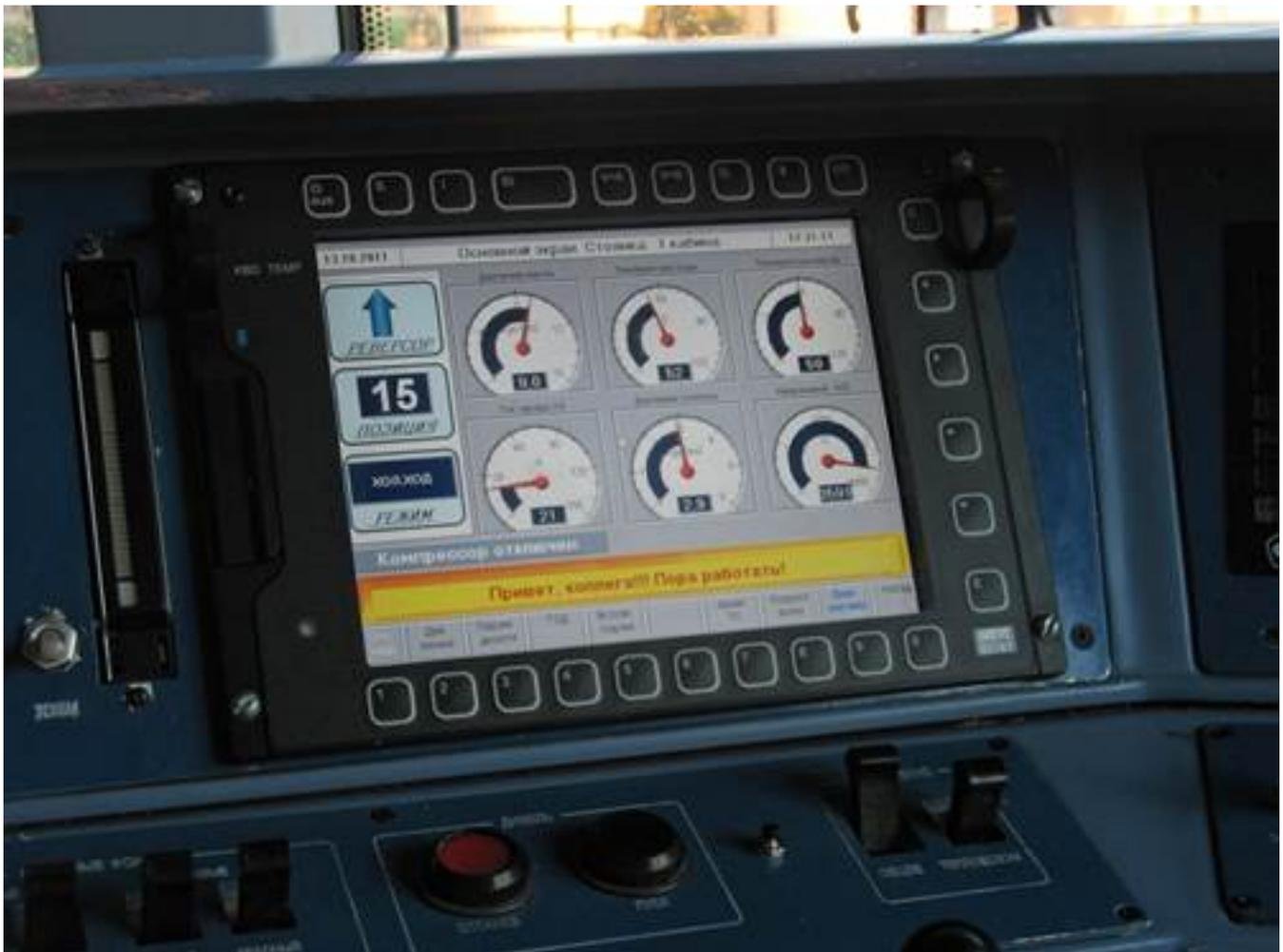
***Рисунок 2. Внешний вид блока ввода информации и индикации БИИ***
