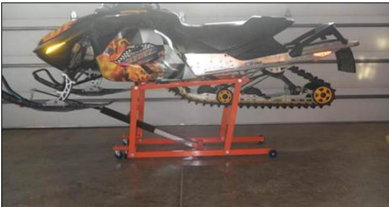
*Рисунок 1. Подъёмник для специальной мототехники*
