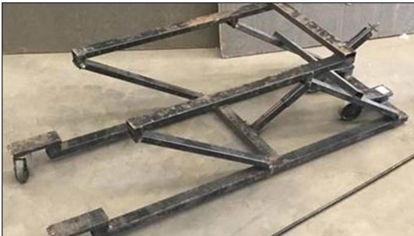
***Рисунок 3. Опытный образец подъемника***
