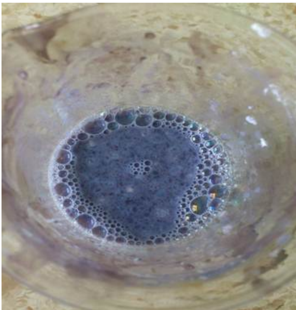
Рисунок 3. Образование пены над раствором
