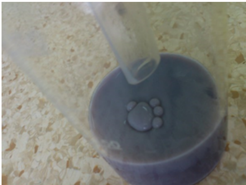
Рисунок 4. Раствор азотнокислой соли тетрадециламина после отделения его от осадка
