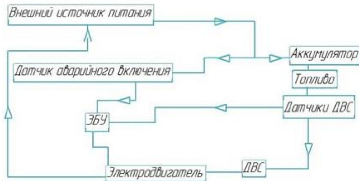
Рисунок 1. Схема работы дизельгенератора с аварийным включением
