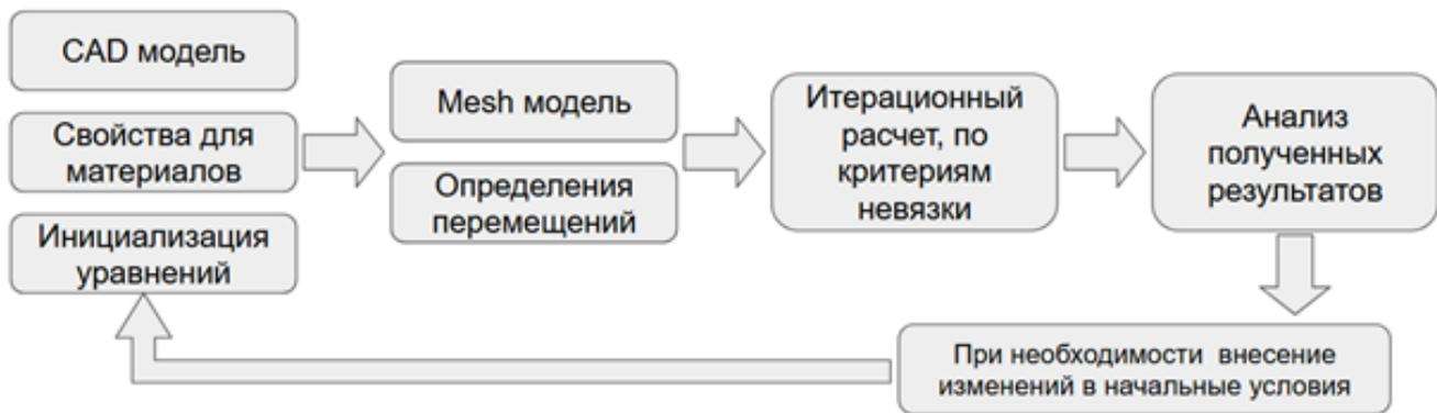
**Рисунок 2. Схема CAE моделирования**
