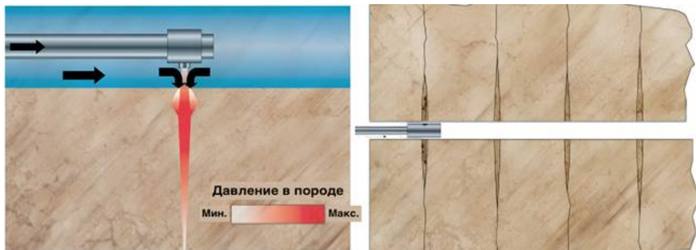
Рисунок 2. Схема эксплуатации инструментальной компоновки «Hydra-Jet™»
