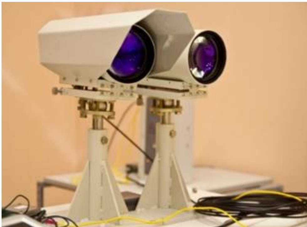
Рисунок 1. Варианты конструкции передающего и приёмного (справа) модулей системы АОЛС
