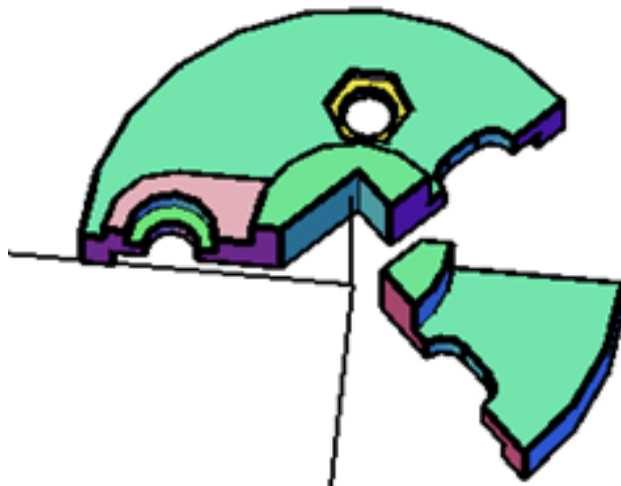
Рисунок 7. Результат помещения частей модели в отдельный слой
