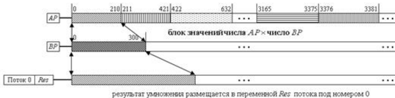
Рисунок 4. Выполнение умножения блока данных числа A на число B потоке с номером 0
